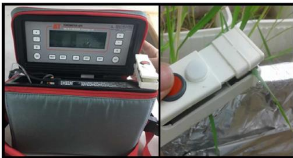
Figure 10: Prise de mesure de la résistance stomatique à l'aide du Poromètre.
